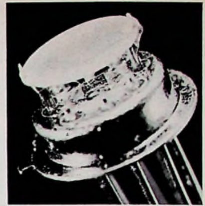
Afb. 7. De F 3187 van Marconi was zo'n vijf jaar geleden de eerste, complete kristaloscillator in TO-5 behuizing, die bestaat uit een kristal (de „grote” schijf boven) en een chip met transistoren, weerstanden en condensatoren (diameter ca. 9 mm, hoogte ca. 7 mm).
